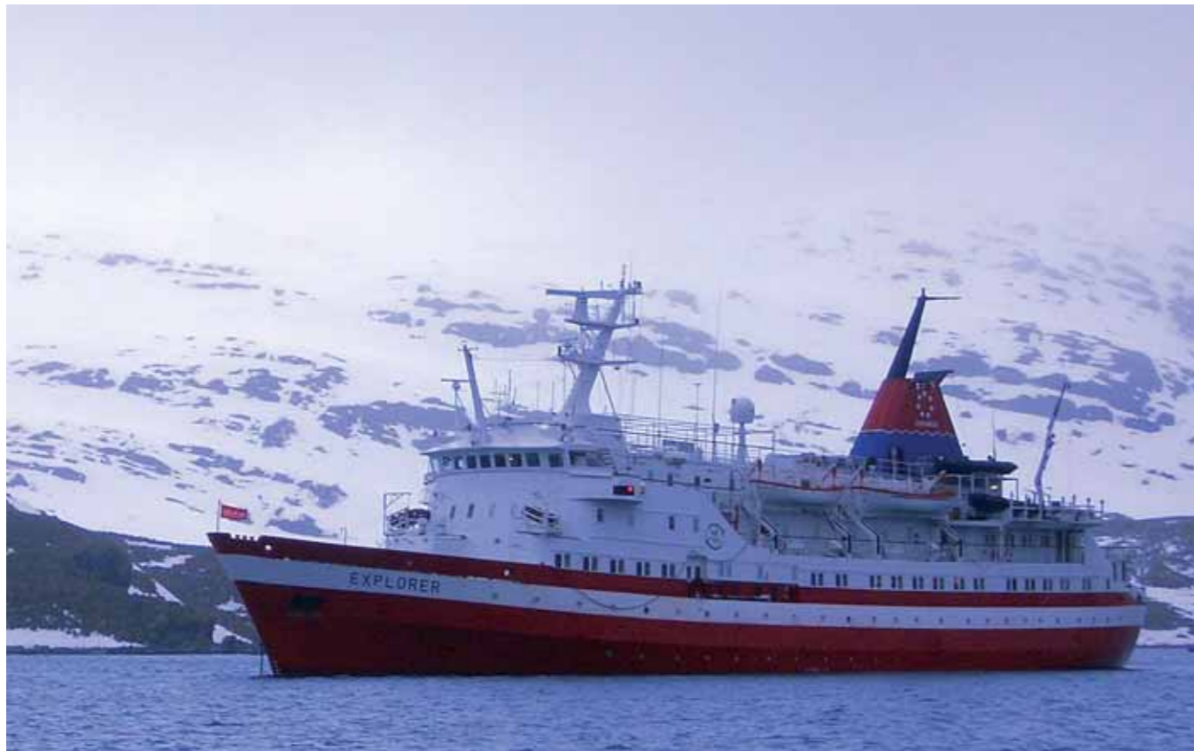
Da war noch klar Schiff: Die «Explorer» vor der Antarktischen Halbinsel. Baujahr 1969, Tiefgang 4,2 Meter, 72,8 Meter lang, 14 Meter breit. Geschwindigkeit: 11 Knoten.
