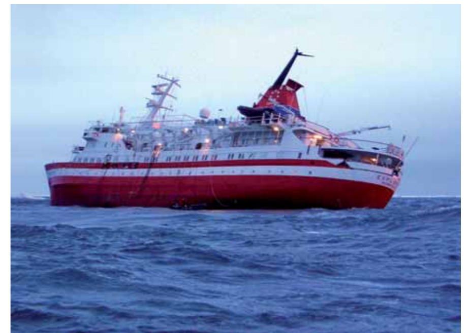
Kurz von Mitternacht rammt die «Explorer» wahrscheinlich einen Eisberg und schlägt leck. Es dringt mehr Wasser ins Schiff, als die Pumpen wieder rausbefördern können.
